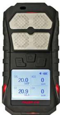
Портативный газоанализатор может контролировать от одного до четырех газов одновременно. ЛИДЕР 041 позволяет осуществлять непрерывный автоматический контроль содержания токсичных газов, летучих органических соединений (ЛОС), кислорода и горючих газов в атмосфере и выдает оповещение об опасных уровнях концентрации: звуковой сигнал, мигающие светодиодные индикаторы и встроенный вибросигнал.
