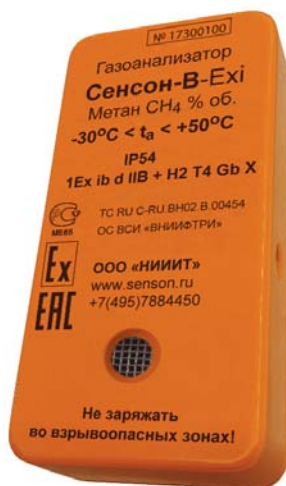
Рис. 2. Индивидуальный газоанализатор "Сенсон-В"
