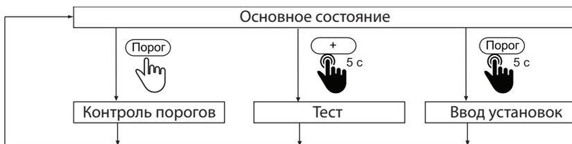
Основное состояние ГС (рабочий режим) – измерение, на индикаторе отображается концентрация. ГС возвращается в основное состояние автоматически, если в течение 30 с не нажимали кнопки. Переход в любой из трех режимов управления происходит только из Основного состояния.
