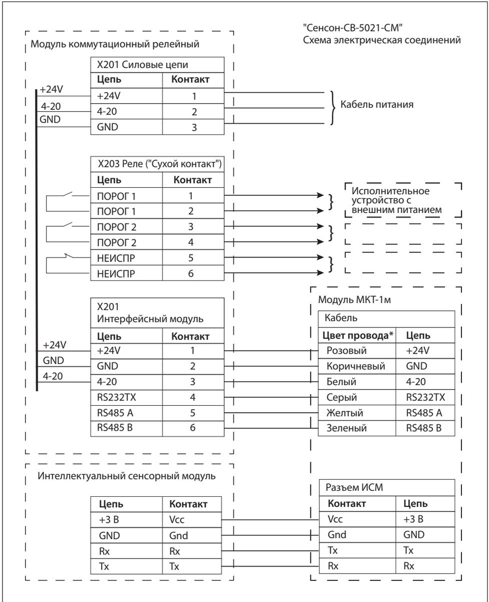
Рис.12. Схема подключения ГС "Сенсон-СВ-5021"-СМ. Цвет проводов может быть иным, см. маркировку на бирке на кабеле и в паспорте прибора
