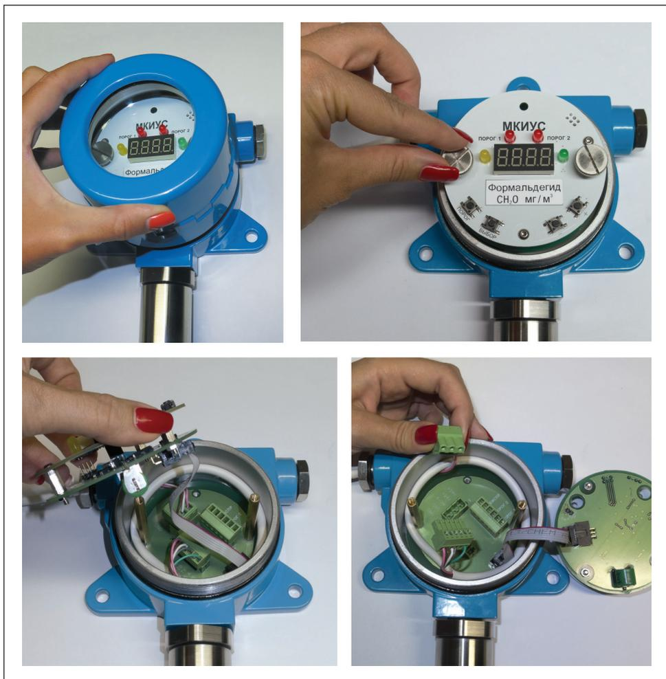
Рис.10. Порядок разборки МКИУС
