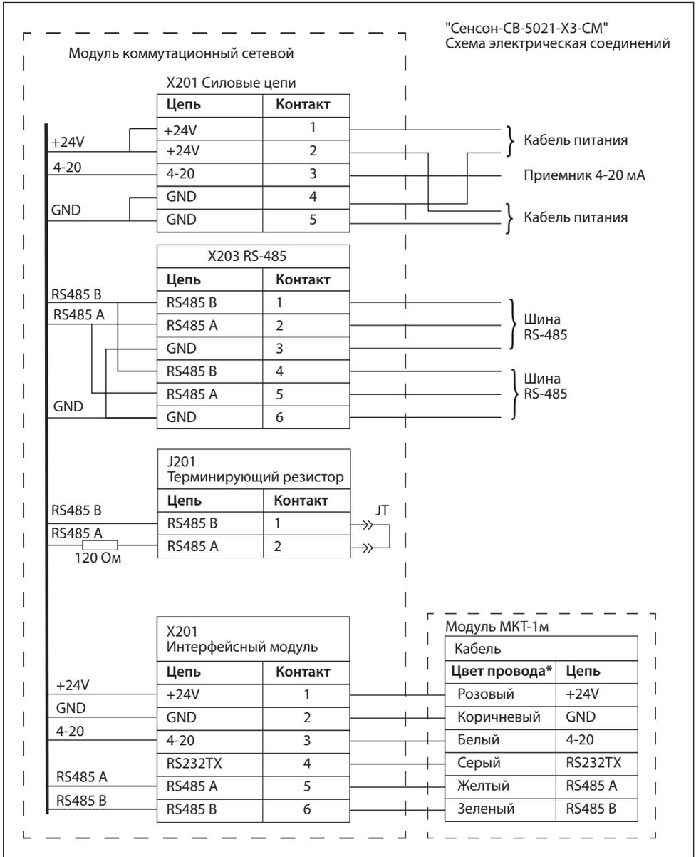
Рис.13. Схема подключения ГС "Сенсон-СВ-5021-Х3-СМ" (сетевой). Цвет проводов может быть иным, см. маркировку на бирке на кабеле и в паспорте прибора
