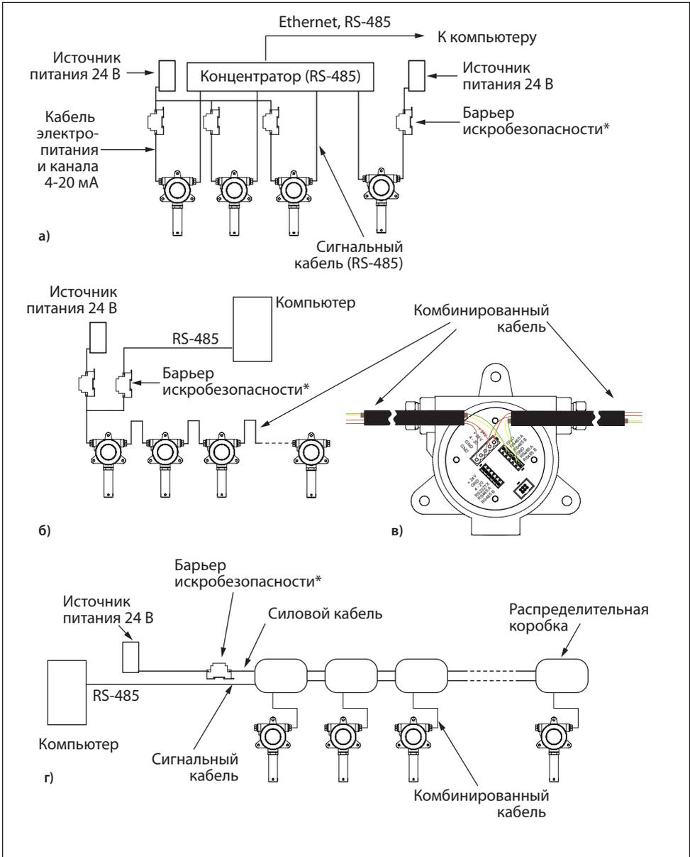
Рис.9. Основные схемы подключения ГС: а) звездой, б) и в) шлейфом с комбинированным кабелем, г) шлейфом с распределительными коробками.
