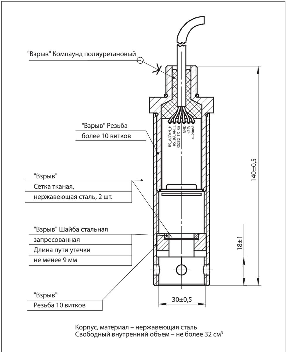
Рис.16. Элементы взрывозащиты типа "взрывонепроницаемая оболочка" модуля MKT-1M
