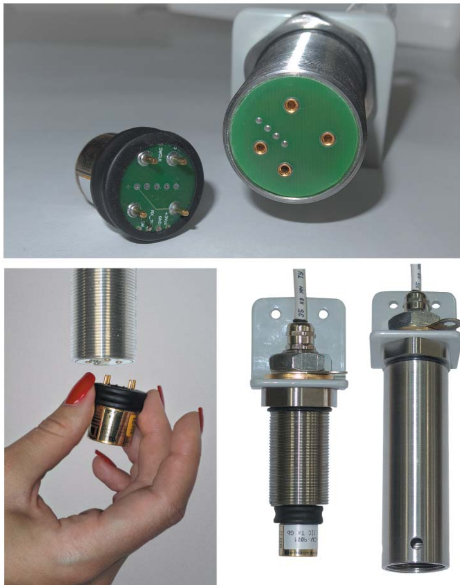
Рис.2. Подключение интеллектуального сенсорного модуля
