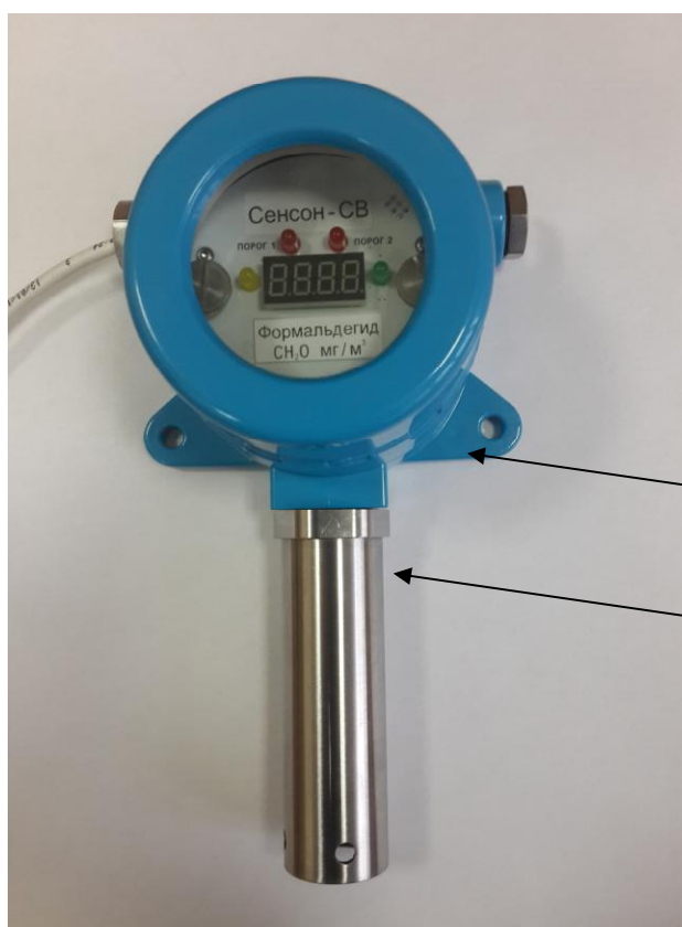
Рисунок 4 - Общий вид исполнения СВ (в металлическом взрывозащищенном корпусе Exd)
